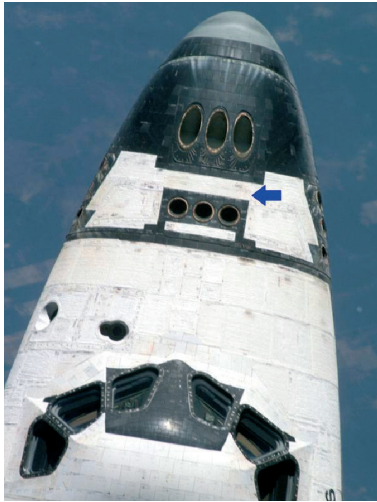
→ Localización (flecha azul) de la manta tipo AFSRI en el transbordador Atlantis. NASA
